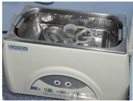
صورة (1.1) التنظيف باستخدام الأمواج فوق الصوتية
